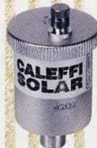
Automatischer Schnellentlüfter für geschlossene, eigensichere Solarheizungen mit Wasser oder Wassergemischen als Wärmeträger nach DIN 4757 BI 7. Max. Arbeitsdruck 10 bar. Max. Betriebstemperatur 150 °C.
