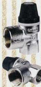
Membran-Sicherheitsventil für geschlossene, eigensichere Solarheizungen mit Wasser oder Wassergemischen als Wärmeträger nach DIN 4757 BI 7. 1/2" IG Anschluss, 3/4" IG Auslass. Ansprechdruck je nach Modell ab 3 bis 10 bar. Nominaldruck PN10. Max. Betriebstemperatur 160°C. TÜV zertifiziert.
