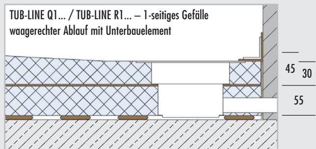
\* Beim Einbau des senkrechten Ablaufs ohne Unterbauelement verringert sich die Gesamthöhe um die Höhe des Unterbauelements (= 55 mm).
