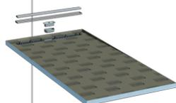
**TUB-LINE BOL**, Hartschaum-Duschbodenelemente für den Ersatz von Badewannen, mit 4-seitigem Gefälle, mit eingebauter und eingedichteter Bodenablaufrinne auf kurzer Seite, mit Abdecksteg und Anfließhilfe aus Edelstahl gebürstet, Abdecksteg rückseitig befliesbar, mit Geruchverschluss, Höhe anpassbar durch Höhenadapter von 5–17 mm. → **Unterbauelemente s. Seite 114–115 / Ablauftechnik und Zubehör s. Seite 134**
