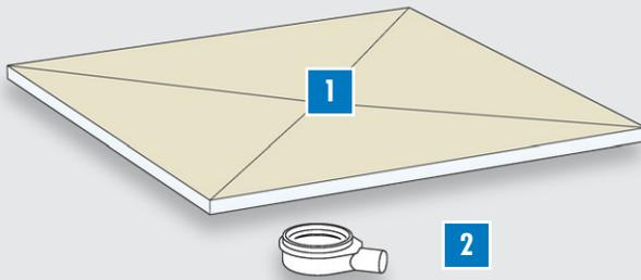
**1 Duschbodenelement** – mit flacher Duschbodenhöhe, werkseitig abgedichtet, quadratisch oder rechteckig, mit vierseitigem Gefälle, integriertes und eingedichtetes Bodenablaufsystem
