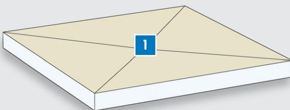
**1 Duschbodenelement** – Kombination von extraflachem Duschboden und waagerechtem Bodenablauf-Stutzen (DN 40 oder DN 50), werkseitig abgedichtet, quadratisch oder rechteckig, je nach Entwässerungsart (Punkt- oder Linienentwässerung) mit ein- oder vierseitigem Gefälle
