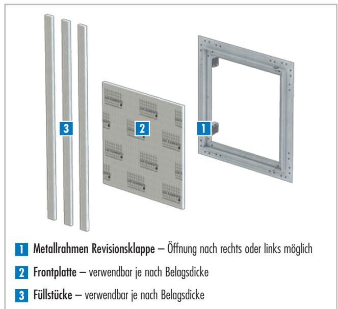
Revisionsklappe ADD-TE REV – Anpassung der Einbauhöhe durch Füllstücke für Belagsdicken von 2 oder 12 mm:
