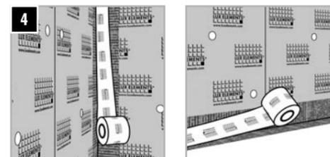
[DE] **Schritt 4** – Der Anschluss an angrenzende/aufgehende Bauteile ist unter Verwendung von LUX ELEMENTS®-DRY-DB(V) (Dichtband) durch Verklebung von LUX ELEMENTS®-DRY-ASK herzustellen (Es gilt die gleiche Systematik wie unter Schritt 2 beschrieben).
