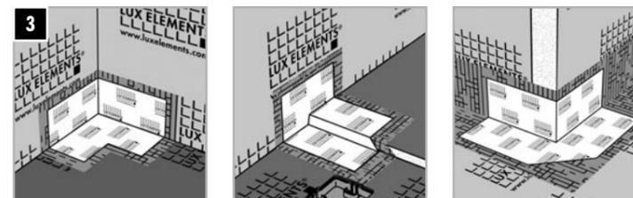
[DE] **Schritt 3** – Für Innen- und Aussenecken sind die vorgefertigten LUX ELEMENTS®-DRY-DB(V)IE (Innenecke), LUX ELEMENTS®-DRY-DBIE LINE L (Innenecke links für TUB-LINE mit einseitigem Gefälle), LUX ELEMENTS®-DRY-DBIE LINE R (Innenecke rechts für TUB-LINE mit einseitigem Gefälle) oder LUX ELEMENTS®-DRY-DB(V)AE (Aussenecke) zu verwenden. Diese werden unter Verwendung von LUX ELEMENTS®-DRY-ASK entsprechend eingeklebt (Es gilt die gleiche Systematik wie unter Schritt 2 beschrieben).
