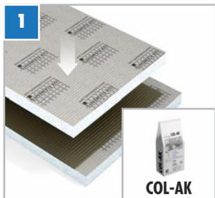
Coller ensemble les éléments d'assise supérieur et inférieur avec COL-AK (**alternative :** COL-MK) de manière à ce que les bords avant des deux éléments soient alignés à fleur. Laisser la colle durcir.
