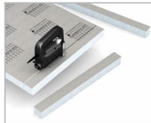
Découper trois bandes de support (1x long = largeur de la niche x 50 mm x 50 mm, 2x court = profondeur du siège -50 mm x 50 mm x 50 mm) dans ELEMENT-EL (Baby) 50.
