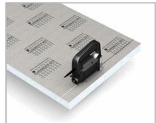
Découper deux éléments d'assise (élément supérieur = largeur de la niche x profondeur du siège x 50 mm, élément inférieur = largeur de la niche -100 mm x profondeur du siège -50 mm x 50 mm) dans ELEMENT-EL (Baby) 50.
